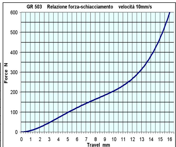
Test in accordo con la norma EN 13856-2 test rod 80 mm, punto di test C3, temperatura 20°C
