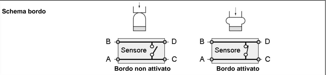
Il bordo sensibile GR-503 è conforme alla normativa EN 13856-2. In abbinamento al modulo di controllo PS3-Ax può raggiungere la CAT 3 - PL e della ISO 13849-1. Considerare questo valore per il calcolo del PL totale della macchina dove questo dispositivo di sicurezza è installato.
